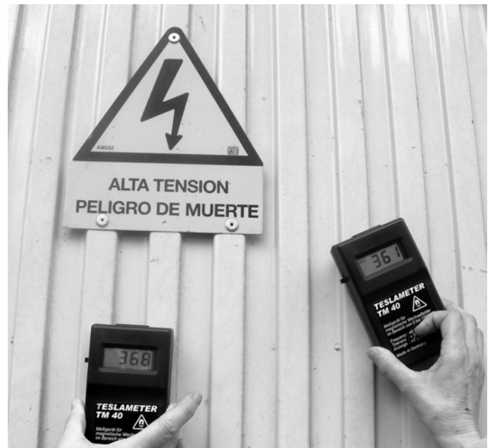
Foto 1.- Medición de campos electromagnéticos con unTeslameter.
